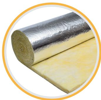
Manta de lã mineral **ODE Starflex 035 AFH** revestida com folha de alumínio que atua como suporte e como barreira de vapor, sendo ideal para o isolamento térmico de condutas. Pode também ser utilizado noutras aplicações em que seja necessário, para além do isolamento térmico e barreira de vapor, isolamento acústico.
